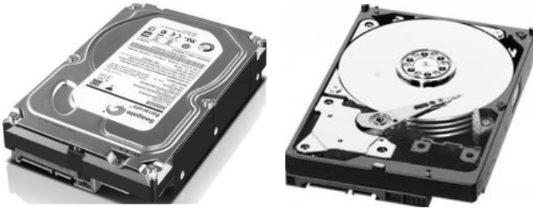
Şək.7.1. Bərk disk - HDD və daxili görünüşü
